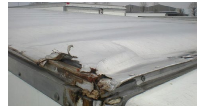
🔄 Padiglione: Telaio danneggiato, pelle dalla riparazione antieconomica
