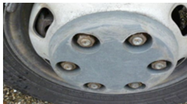
Cerchi e copriruota: Graffi superficiali multipli con o senza rimozione di materiale
