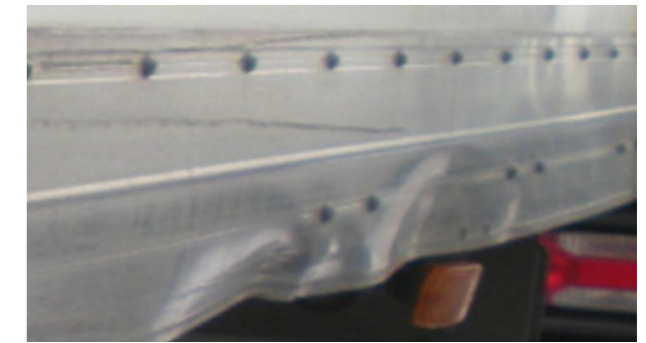
Profili laterali nel sottoscocca: Deformazioni dalla riparazione antieconomica, perforazioni, stacco di una sezione del profilo
