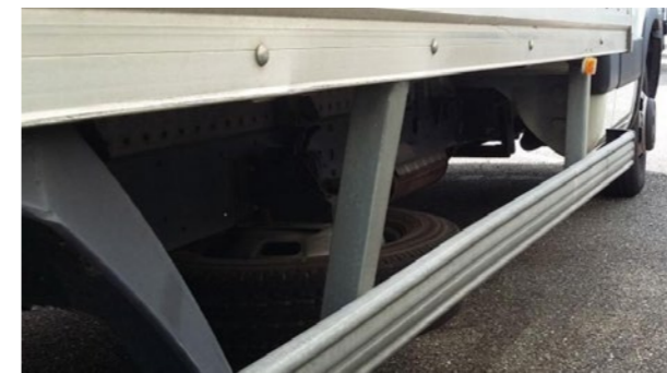
Barre di protezione: deformazione dalla riparazione economicamente conveniente
