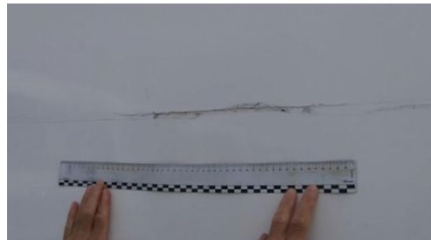
Fiancate: Graffio con rimozione di materiale \geq 20 cm dalla riparazione economicamente conveniente. Possibilità di verniciare mezzo pannello
