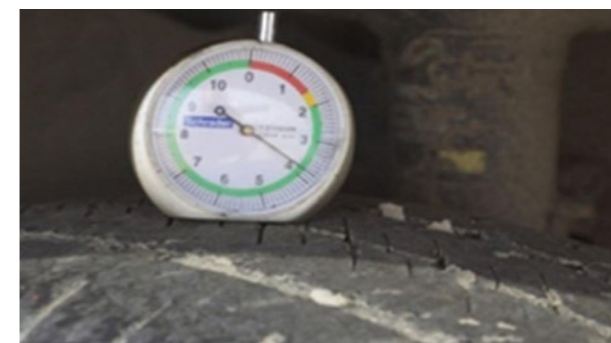
Pneumatici: Base della scanalatura < 5 mm di profondità Nota: l'usura degli pneumatici si misura nella scanalatura maggiormente usurata dello pneumatico.
