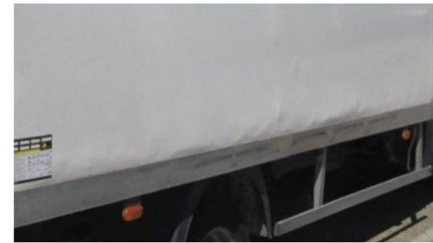
Fiancate in fibra: Deformazione nella parte inferiore, lunghezza > 1 m Nota: la sostituzione del pannello anteriore nella sottoscocca richiede lo stacco di questa.
